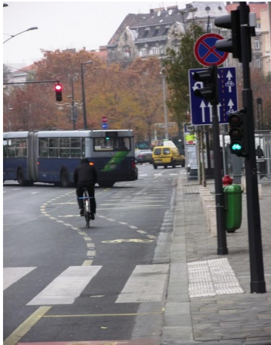
39. ábra Kerékpársáv kialakítása buszmegálló mellett
