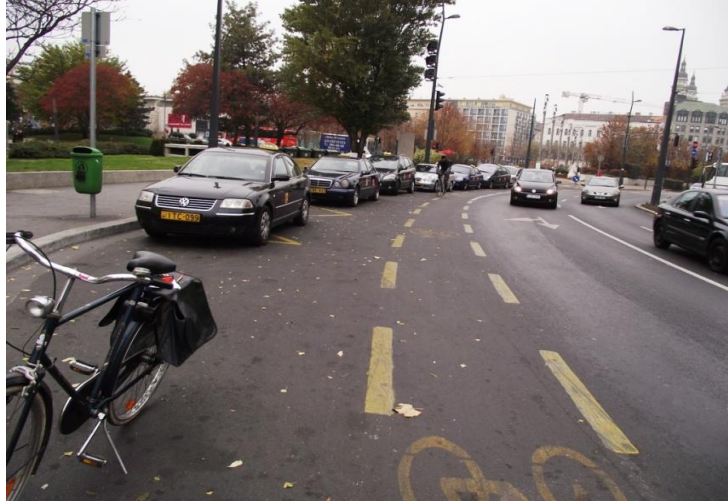
42. ábra Kerékpársáv kétoldali terelővonallal
