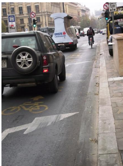
45. ábra Kerékpáros nyom a forgalmi sáv tengelyében
